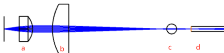
Figure 4. Optical path simulation diagram 图 4. 光斑压缩光路图
